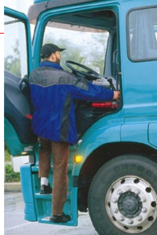
Unpraktisch: Mit treppenförmig angeordneten Stufen könnte der Einstieg noch bequemer sein.
