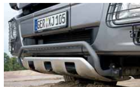
Die neue Panzerung bäuchlings kommt im Bau-Actros serienmäßig.
