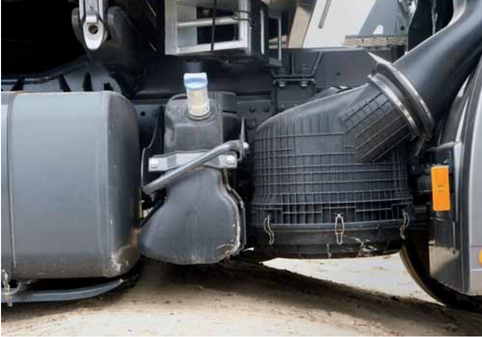
Dank neuer Panzerplatte (links unten) ficht den Kraftstofftank so schnell nichts an.
