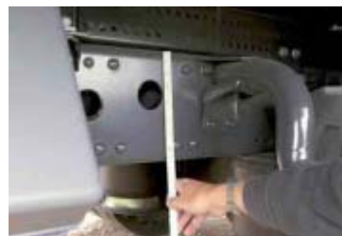
Die Rahmenhöhe des 1222 nR misst 800 Millimeter – 70 weniger als zuvor.
