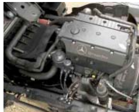
Kurz, kompakt und leistungsstark gibt sich der 218 PS starke Vierzylinder.
