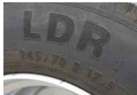
Die 17,5 Zoll großen Räder sparen rund 30 Millimeter im Halbmesser.
