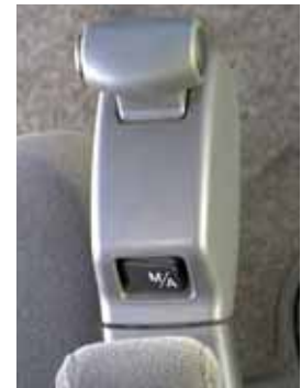
Die Bedienung der Powershift-Automatik ist in einen Ausleger am Sitz montiert.
