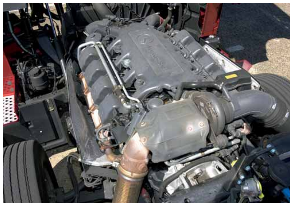
15,6 Liter Hubraum verteilt auf acht Zylinder, ein Turbolader für beide Zylinderbänke.
