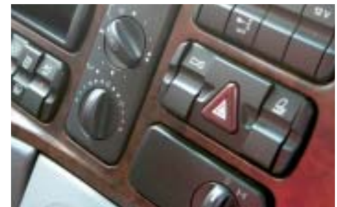
Dank CAN-Bus lassen sich die Schalter im Actros problemlos umstecken.
