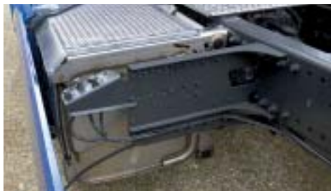
Im Schalldämpfer hat der Katalysator seinen Platz.
