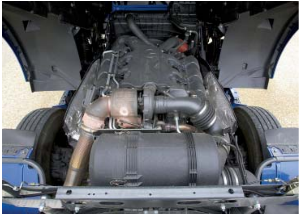
Ein zentraler Turbolader versorgt die beiden Zylinderreihen des Euro-5-Motors.
