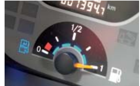
Unter dem Tachometer sitzt eine separate Adblue-Füllstandsanzeige.
