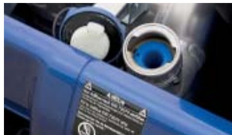
Bis zu 145 Liter fassen die für den Actros lieferbaren Adblue-Tanks.
