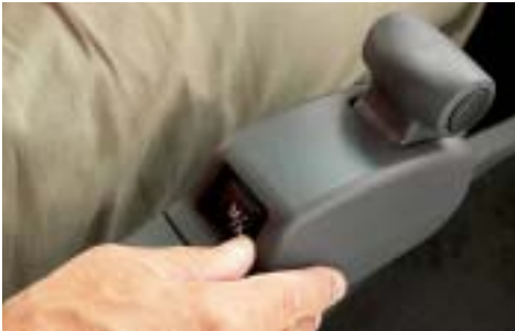
Schalthebel mit Wählschalter Automatik/Manuell an der Armlehne.
