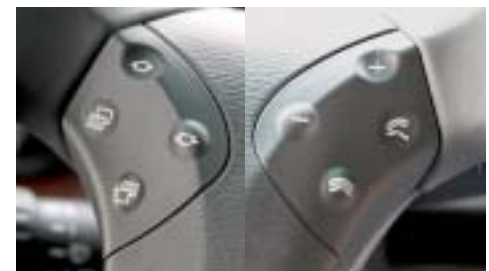
Bedienung von Bordcomputer, Telefon und Radio über die Lenkradtasten.
