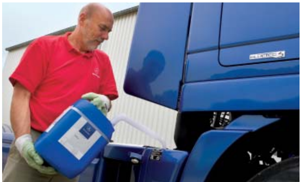
Der Adblue-Verbrauch des Euro-5-Motors lag bei 4,1 Prozent des Dieselkonsums.
