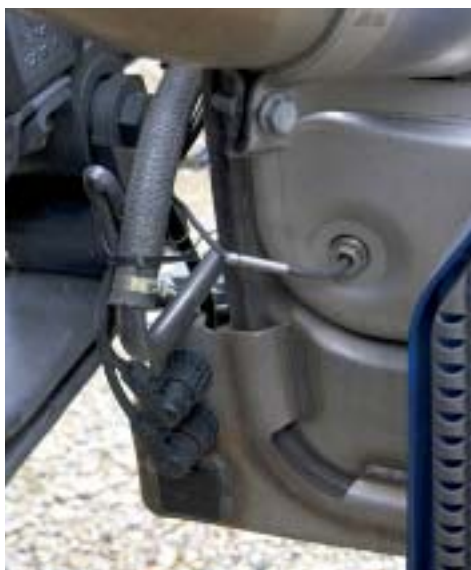
Die Tanks mit dem Reduktionsmittel werden vom Kühlwasser des Motors beheizt.
