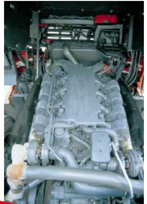
In seiner stärksten Einstellung leistet der Achtzylinder von Mercedes exakt 420 kW oder 571 PS.
