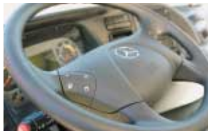
Die Bedienung von Radio, Telefon und Menü geschieht über Lenkradtasten.
