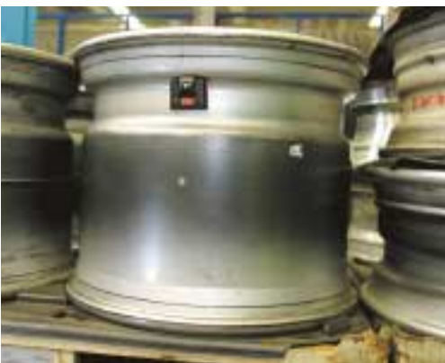
Gewaltige Abmessungen haben die Felgen für die Super-Single-Bereifung.
