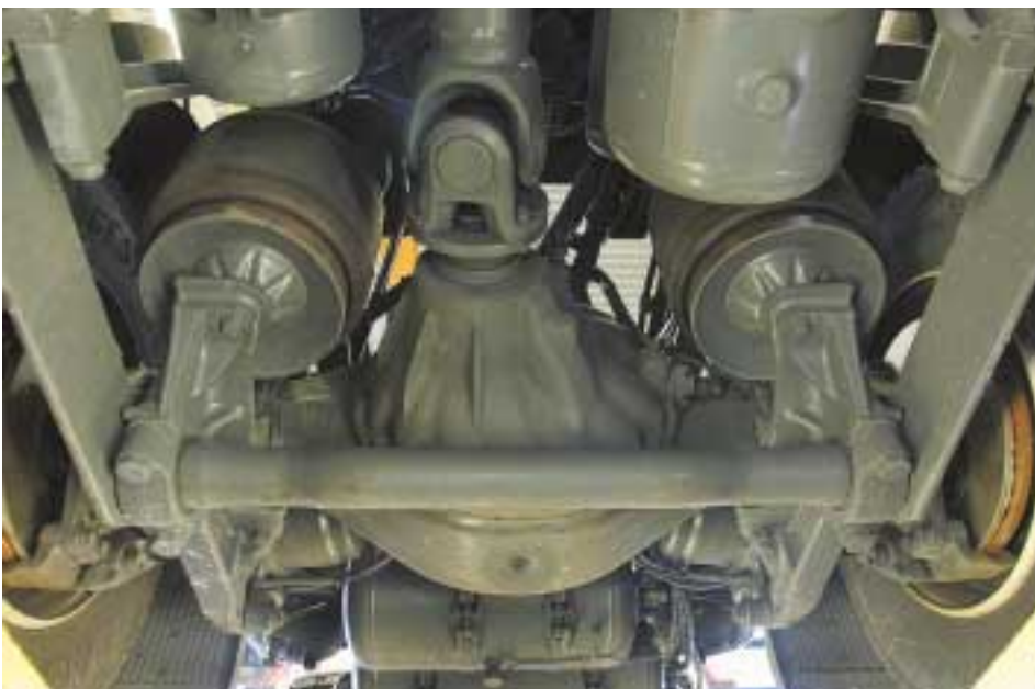
Die neue Zweibalg-Luftfederung des Actros spart 20 bis 30 Kilogramm Gewicht.
