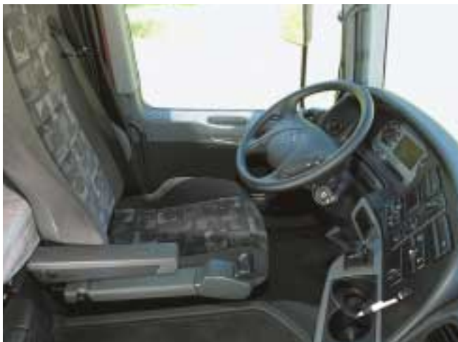
Der neu konzipierte Fahrersitz mit nach oben wegklappbarer Schaltwippe überzeugt durch hohen Komfort.
