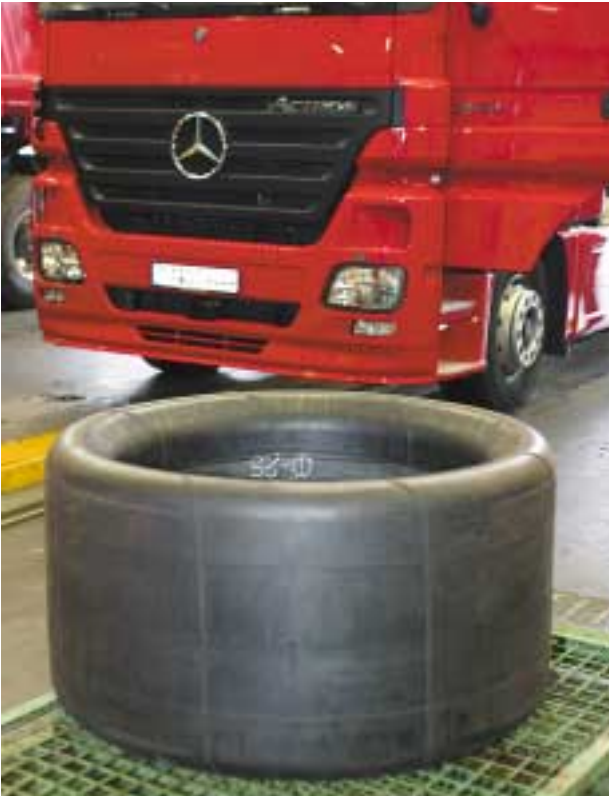
Im Falle eines Reifenplatzens soll der innenliegende Stützschlauch größeres Unheil abwenden.
