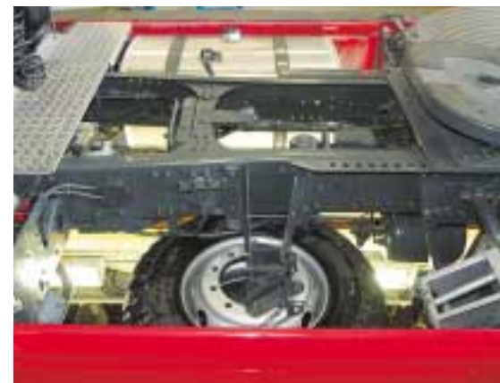
Mehr Schraubverbindungen denn je kennzeichnen den Rahmen.
