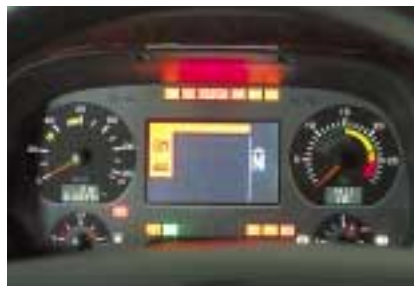
Den zentralen Platz im Instrument besetzt ein großes Weißlicht-Display.
