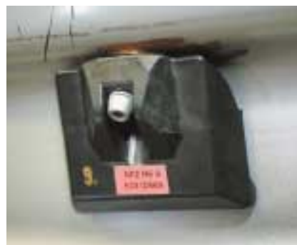
Bei Druckluftverlust schlägt die Fülldruck-Überwachung von Beru Alarm.
