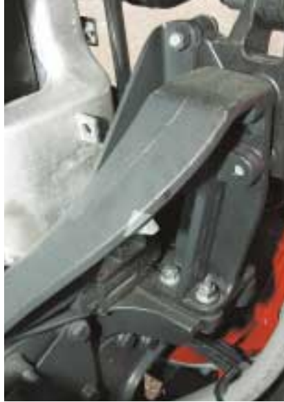
Ein neues Crash-Element soll die Kabine auf dem Rahmen stabilisieren.
