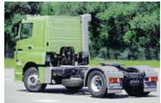
Fahrfertig und mit 300 Liter vollgetankt wiegt der Axor rund 6,4 Tonnen.
