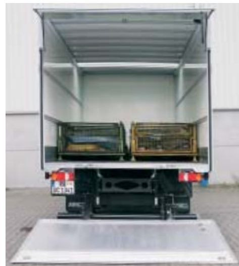
Mit seiner hinteren Luftfederung kann der Atego sein Heck auf 1,2 Meter heben.
