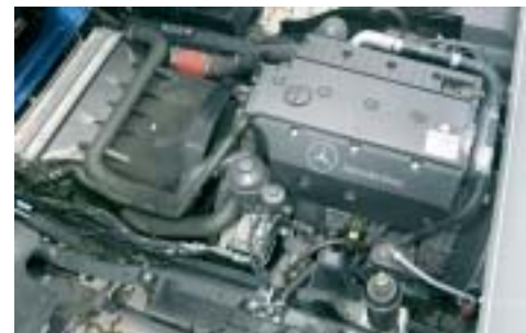
Vier Zylinder, kerniger Lauf und 177 PS bietet der 4,25 Liter große OM 904 LA.
