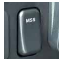
Der MSS-Schalter ist der einzige Hinweis auf die Start-/Stopp-Automatik.
