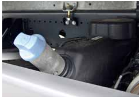
Für den Atego sind drei verschiedene Adblue-Tankgrößen verfügbar (8, 25, 35 Liter).
