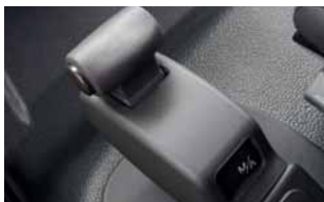
Wählhebel der optionalen Telligent-Schaltung mit Taster für manuellen Modus.
