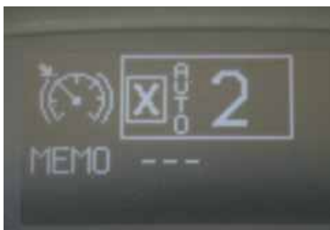
Im Display signalisiert ebenfalls ein „X“, dass der Geländemodus eingelegt ist.
