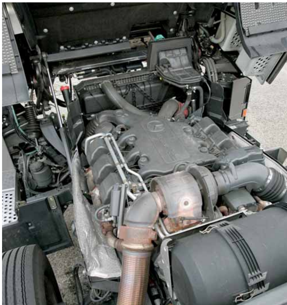
Der V6 ist im Lkw eine Rarität. Alle anderen Hersteller setzen auf Reihenmotoren.
