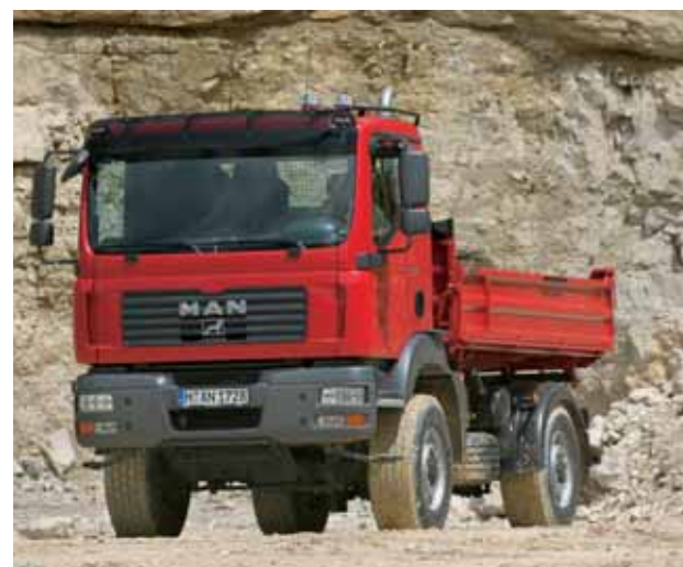
Im Gelände fühlt sich der allradgetriebene und einzelbereifte 13-Tonner pudelwohl.
