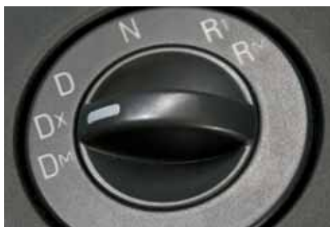
Steht der Zeiger auf „Dx“, ist die spezielle Geländesoftwre der Tipmatic aktiviert.
