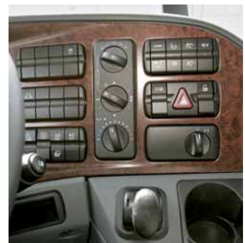
Drei übereinander angeordnete Drehschalter für Heizung und Lüftung.
