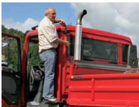
Hinten links an der kurzen Kabine gibt es einen praktischen Tritt.
