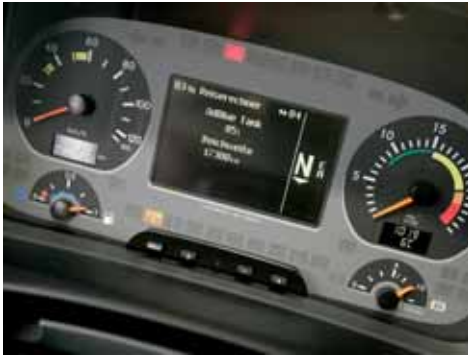
Weitgehend blendfreie Rundinstrumente und ein gut ablesbares zentrales Display.
