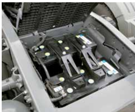
Die Batterien im Heck machen Platz für Adblue, Katalysator und große Dieseltanks.
