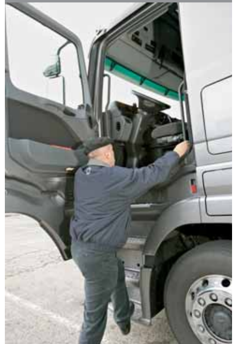
Fast 1600 Millimeter misst der steile Einstieg ins hoch montierte Fahrerhaus.
