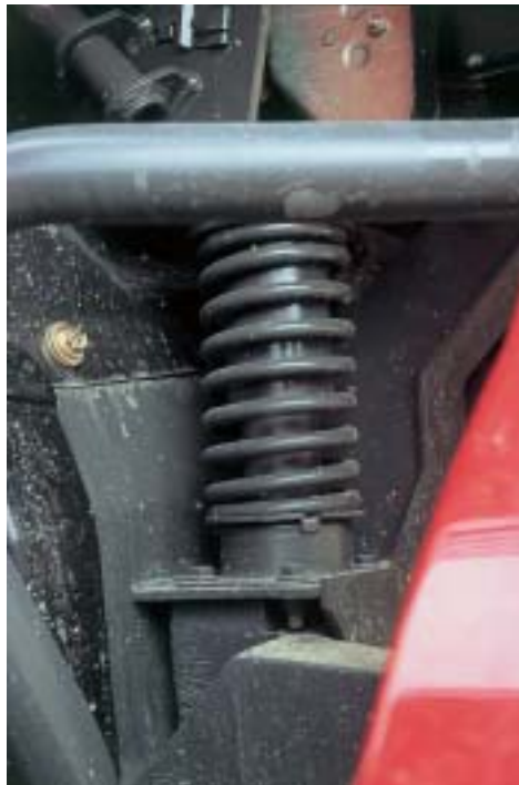
Das Fahrerhaus lagert auf gut abgestimmten Schraubenfedern.
