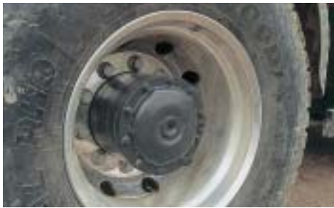
Für hohe Bodenfreiheit stehen die bewährten Außenplanetenachsen.
