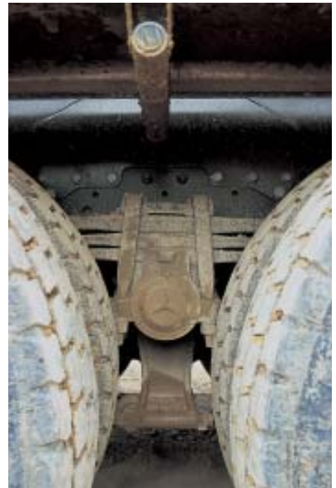
Gewichtsoptimierte Parabelfedern an allen Achsen helfen, Gewicht zu sparen.
