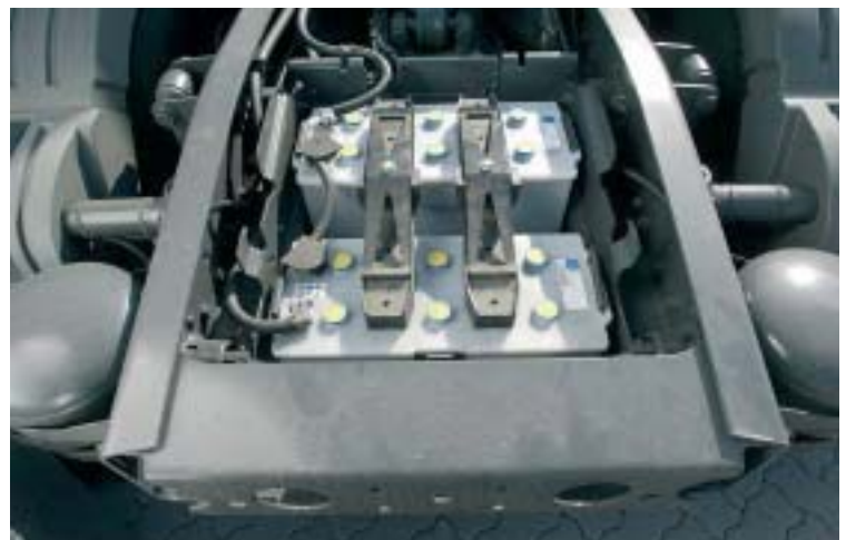
Die ins Heck verlegten Batterien lassen Platz für den künftigen Ad-Blue-Tank.
