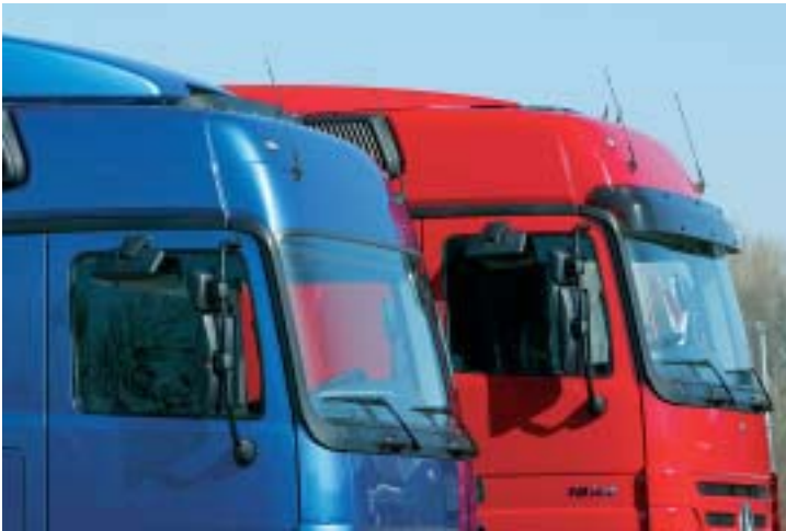
Das Megaspace-Haus ist rund 250 Millimeter höher montiert.
