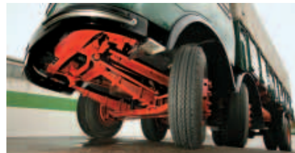
Hohe Spurtreue und sagenhafter Fahrkomfort dank zwei gelenkter Vorderachsen.
