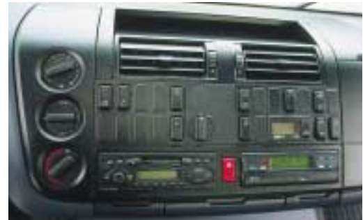
Im Mittelteil sind Schalter, Radio, Tachograf und Lüftung zusammengefasst.
