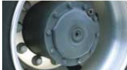
Für eine niedrige Rahmenhöhe ist die Außenplanetenachse nötig.
