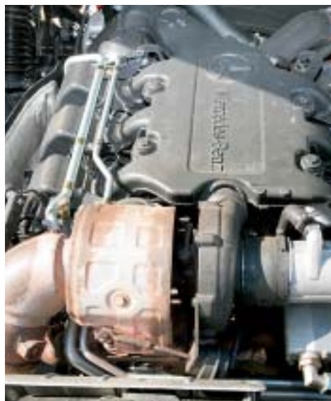
Ein großer Turbolader versorgt beide Zylinderreihen des V6-Motors.
