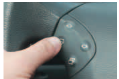
Lenkradtasten für Radio, Telefon und Fahrer-Informationssystem.
