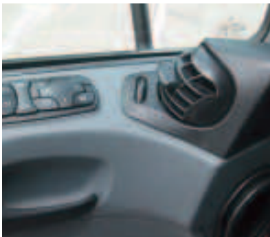
Eine große Wirkung haben die drehbaren Düsen in den Türen.
