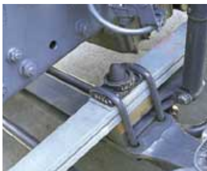
Nimm zwei: Die Zweiblatt-Federung arbeitet besser als die Dreiblattlösung.
