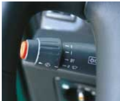
Mangelnde Stabilität: Bestimmte Kombischalter neigten dazu, zu brechen.
