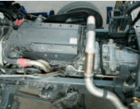
Der Sechszylinder wuchs von 6,37 auf 7,2 Liter Hubraum.
