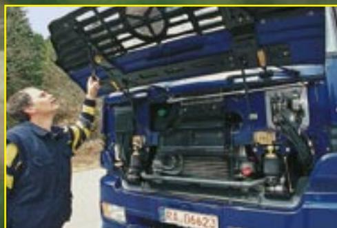
Alle Wartungspunkte sind hinter der großen Klappe zentral zusammengefaßt.
