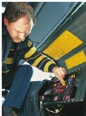
Auf der Beifahrerseite sind Sicherungen, Relais und Elektronik untergebracht.
