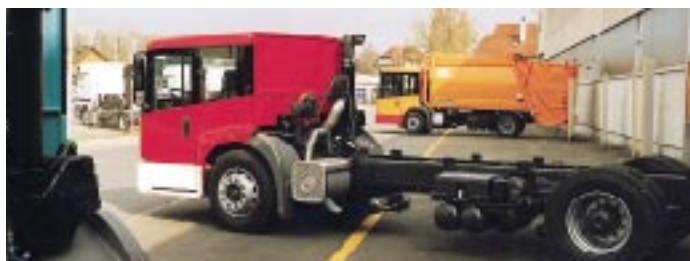
Eonic-Fahrgestell mit niedriger Kabine, beispielsweise für Feuerwehraufbauten.
