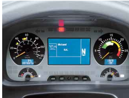
Die neuen Instrumente sitzen in einer Mulde und sind fast blendfrei.
