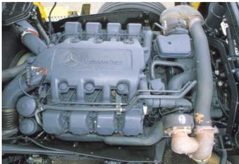
Mit fast 16 Liter Hubraum schöpft der Achtzylinder aus dem Vollen und überzeugt mit Laufkultur, kräftigem Antritt und hoher Motorbremsleistung. Euro 3 kostet 5000 Mark Aufpreis.
