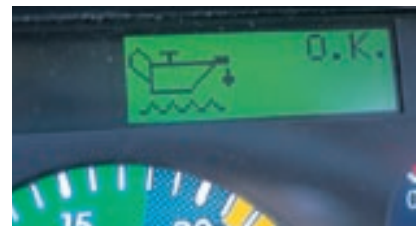
Alles klar: Die Motorelektronik fungiert als automatische Abfahrtskontrolle.
