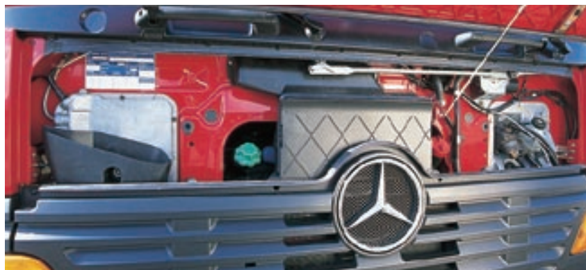
Kleine Klappe und wenig dahinter: Das Prüfen der Pegelstände besorgt im schweren Atego die Elektronik. Nur noch zum Nachfüllen muß der Fahrer an die Front.
