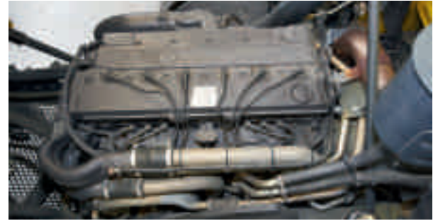
Optischer Unterschied zum Diesel: Zündkabel und -spulen.
