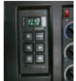
Einfach zu bedienen und in Serie in jedem Econic: eine Allison-Automatik aus der Serie 3500.
