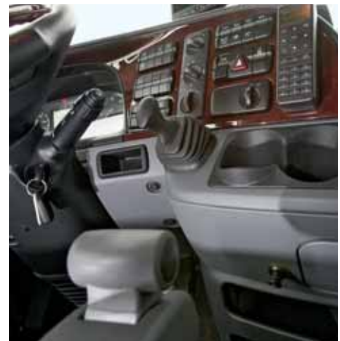
Powershift-Wählhebel auf einem langem Ausleger rechts am Fahrersitz.
