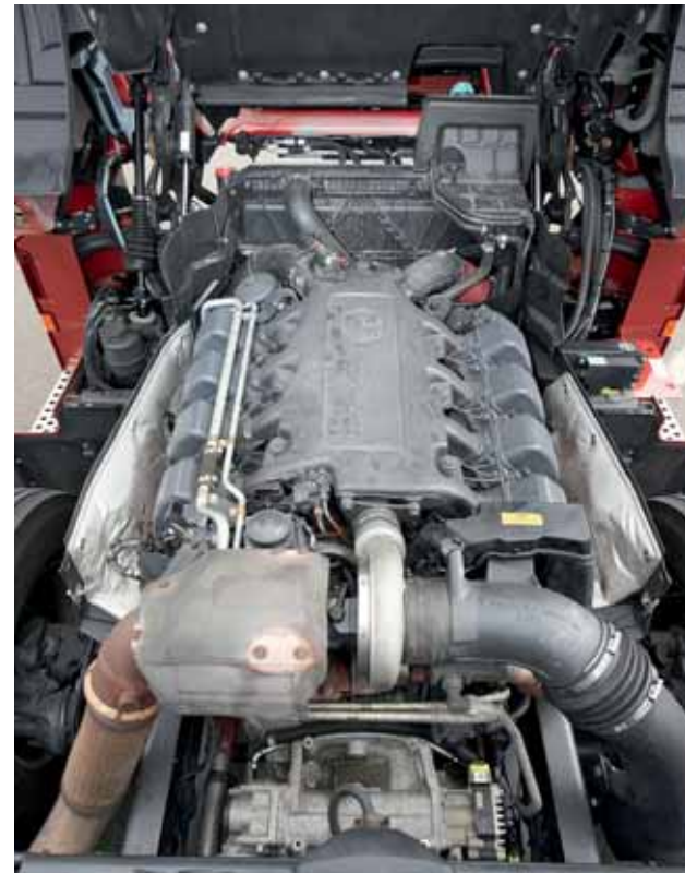
Acht Zylinder in V-Form, 15,9 Liter Hubraum, ein zentraler Turbolader.
