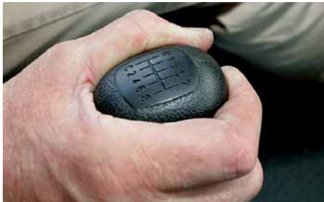
Serienmäßig mit Neunganggetriebe und Doppel-H-Schaltung.
