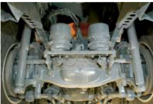
Hoch droben siedeln die Bremszylinder in geschützter Lage.
