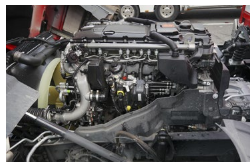
Der neue Common-Rail-Sechszylinder baut etwas höher als der alte Atego-Antrieb.
