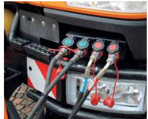
Auch den U 20 gibt es auf Wunsch mit einer Zweikreis-Arbeitshydraulik.
