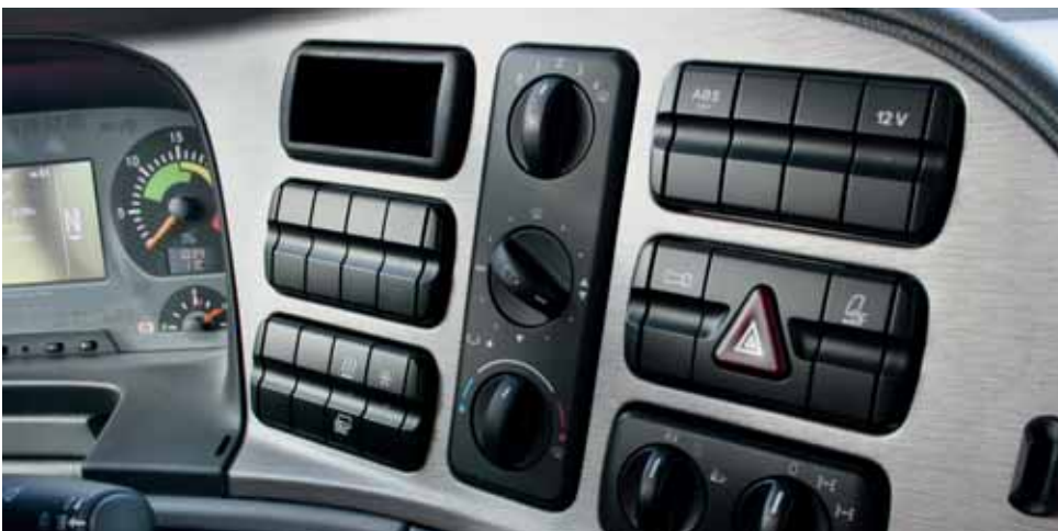
Auch das abschaltbare ABS und die Rollsperrung am Armaturenbrett sind gut zu erreichen.
