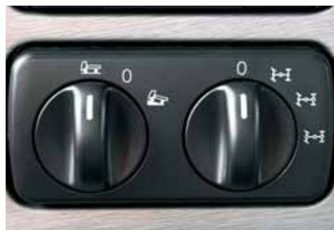
Links der Schalter für den Geländegang, rechts der Drehknopf für die Sperren.
