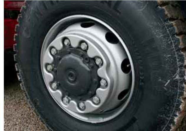
Angetriebene Außenplanetenachsen (siehe Bild ganz oben) hat der Allradler auch vorn.
