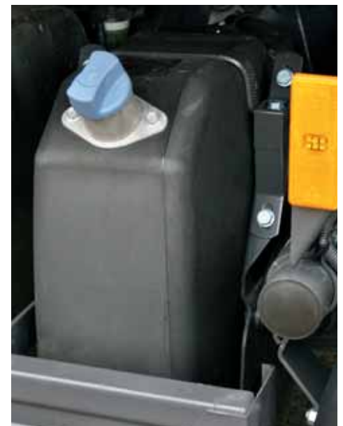
Ohne Adblue-Tank verlässt kein europäischer Kipper mehr das Werk.
