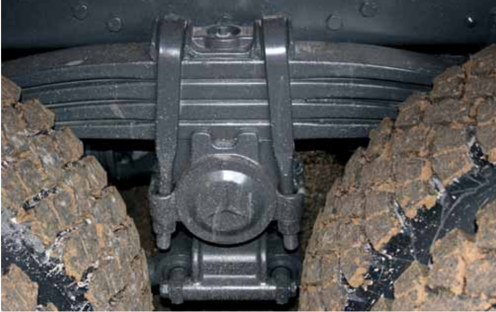
Als harte Burschen treten die vierlagigen Parabelfedern hinten an.
