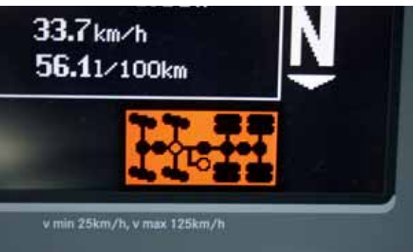
Wenn alle Sperren geschaltet sind, leuchtet dieses Symbol auf.
