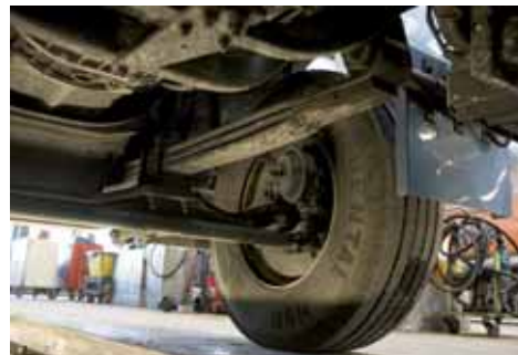
Drei Parabelfedern an der Vorderachse sind im Kipper Standard.
