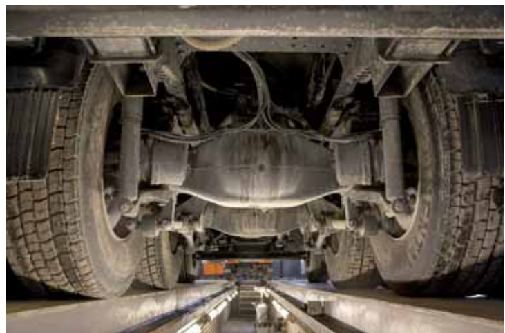
Herkömmliche Stabilisatoren und Stahlfedern im Axor.
