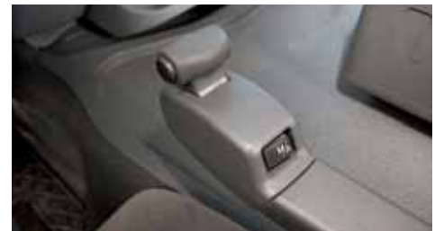
Der Actros verfügt traditionell über eine halbautomatische Schaltung.
