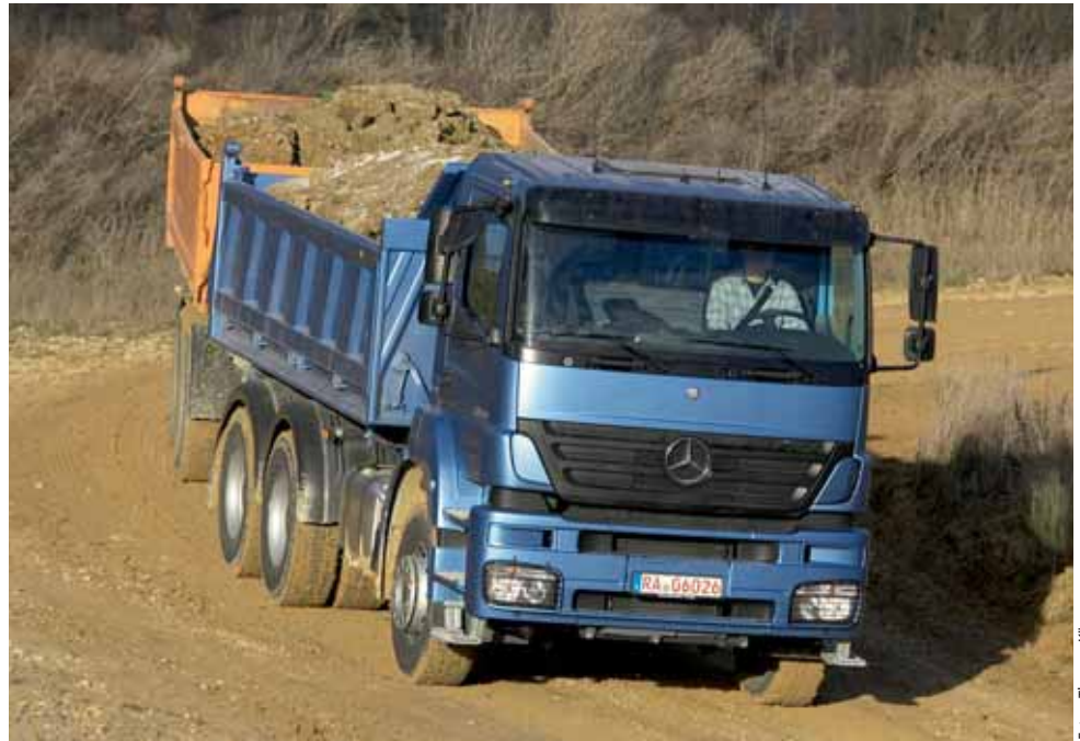
Im Axor 2643 arbeitet ein Reihensechszylinder mit 428 PS.
