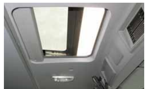
Im Actros verwöhnt ein elektrisch betätigtes Schiebedach den Fahrer.
