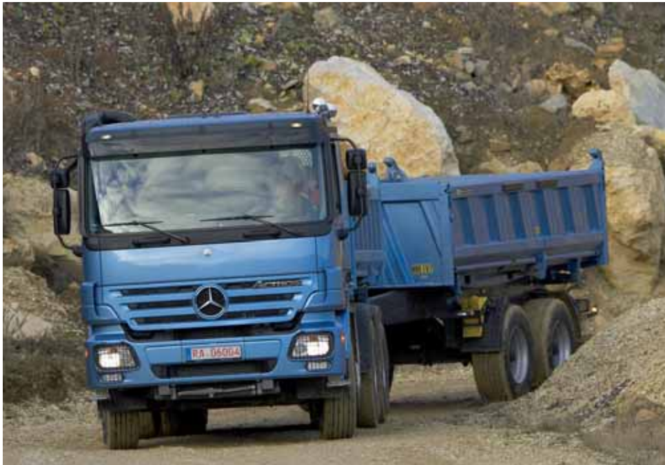
Der Actros setzt traditionell auf einen V6, der im 2644 genau 435 PS leistet.
