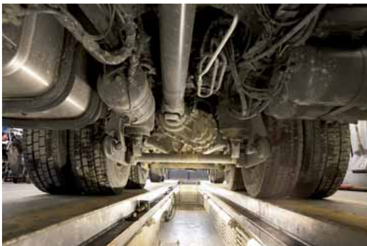
Die Hinterachsen im Actros mit acht Luftbälgen und Stabilenker.
