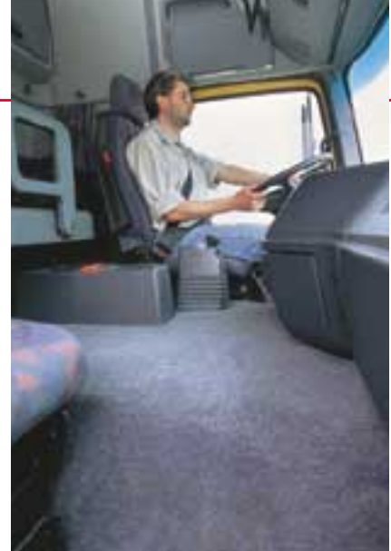
Der Motortunnel ragt etwa 300 Millimeter ins L-Fahrerhaus des 1840.
