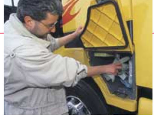
Im L-Fahrerhaus hängen die Außenstauflächen unter dem Kabinenboden im Radlauf.
