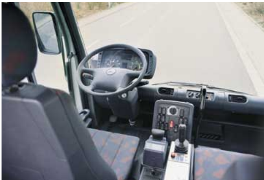
Schaltung und Hydrauliksteuerung sind auf der Mittelkonsole angebracht.
