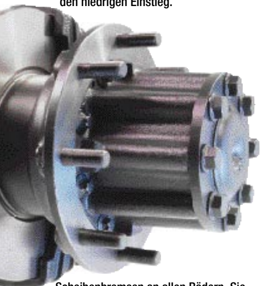
Scheibenbremsen an allen Rädern. Sie arbeiten mit zehn bar Betriebsbremsdruck.
