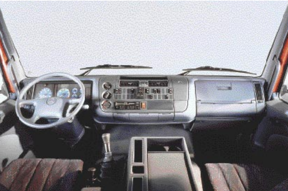
Dreigeteiltes Armaturenbrett: links das neue Kombi-Instrument, in der Mitte die Bedienung für Heizung, Lüftung, Klima und DIN-Einschübe, rechts das Handschuhfach.
