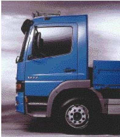
Das normale S-Fahrerhaus ist 1650 Millimeter, eine verlängerte Variante 1830 Millimeter lang. Das Fernverkehrs-Fahrerhaus hat eine Länge von 2250 Millimeter.
