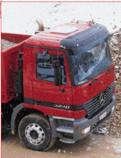
Der kleine Unterschied: 60 Kilogramm liegen zwischen S- und M-Kabine.
