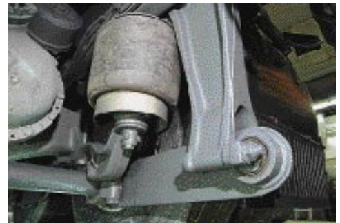
Wem das noch nicht genügt, der kann zur luftgefederten Hinterachse greifen.
