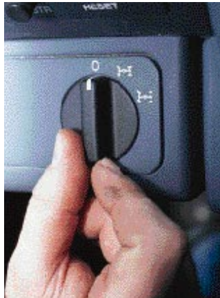
Erst längs, dann quer: So stimmt die Sperren-Reihenfolge immer.
