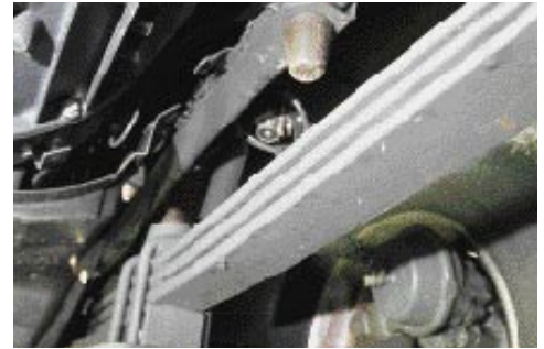
Parabelfedern an allen Achsen stellen viel Nutzlast und Komfort sicher.
