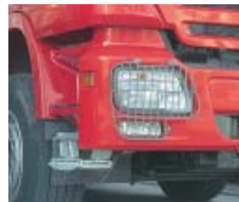
Auf Wunsch schützen Gitter die neuen Scheinwerfer vor Steinschlag.
