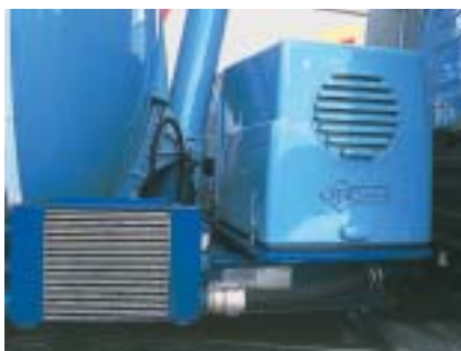
Ein Kompressor mit Dieselmotor macht die Auflieger autark.
