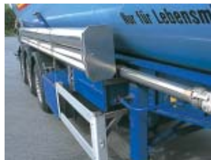
Rohre aus einer besonderen Stahllegierung sind wesentlich haltbarer.
