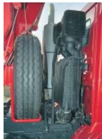
Die Luftansaugung reckt sich beim Kipper rechts hinten gen Himmel.
