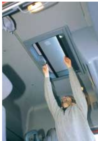
Elektrisch betätigtes Hubdach mit Sonnenrollo und Fliegengitter.
