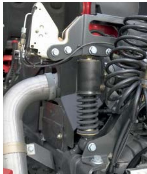
Schraubenfedern mit hohem Komfort.
