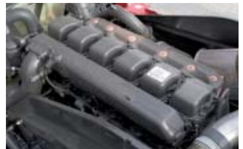
Der OM 457 LA mit sechs Zylindern in Reihe und knapp zwölf Liter Hubraum.
