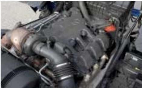
Der V6-Motor baut breiter als der R6-Antrieb, aber nicht ganz so hoch.
