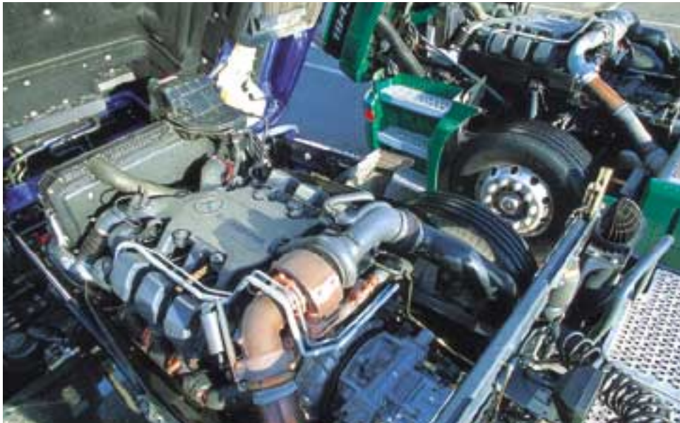
Nur kleine Änderungen am Auspuffkrümmer und der größere Ladeluftkühler machen äußerlich den Unterschied zwischen Euro 2 und Euro 3.
