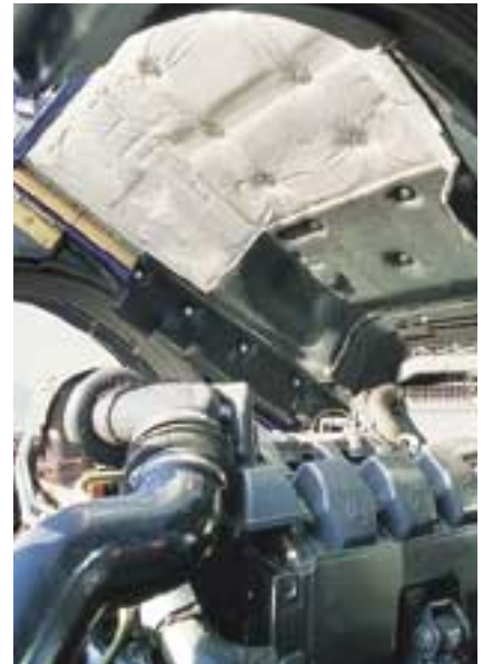
Ein Turbolader versorgt beide Zylinderreihen des V6-Motors.
