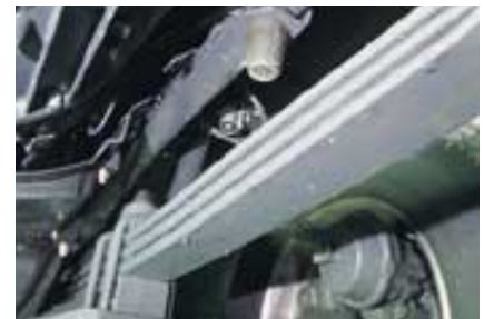
Bei den Baufahrzeugen sind Parabelfedern rundum Serie.
