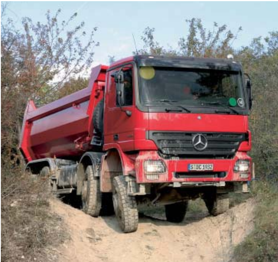
Der 8x8-Actros ist mit V6- und V8-Motoren lieferbar, die bis zu 510 PS leisten.
