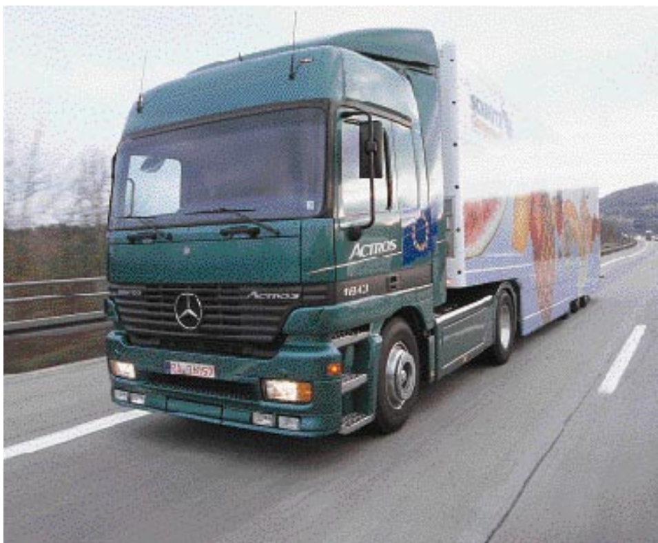
In ausgiebigen Vergleichsfahrten erprobte lastauto omnibus die Schaltautomatik EAS im Vergleich zur manuellen Schaltung. Ergebnis: EAS ist so gut wie ein Top-Fahrer.
