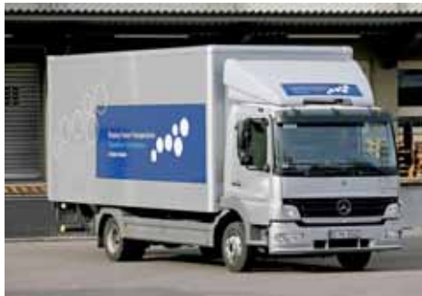
Japan-Technik im Atego Hybrid: Der 7,5-Tonner übernimmt den Canter-Triebstrang.
