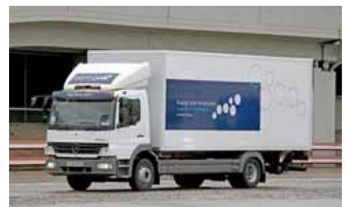
Atego Hybrid als Zwölftonner: drahtiger Vierzylinder plus Technik von Freightliner.
