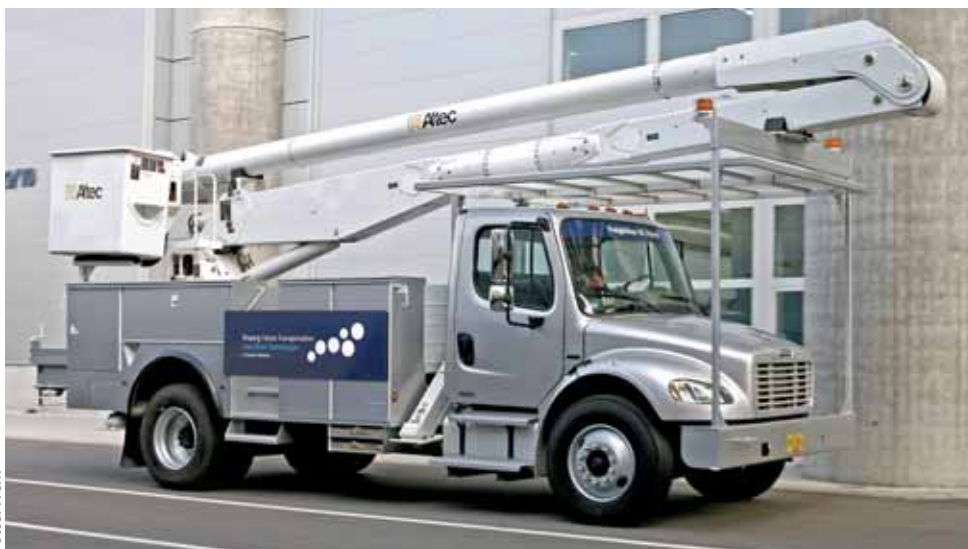
Freightliner M2 mit Hybridantrieb: Auch der Nebenantrieb wird elektrisch angesteuert.
