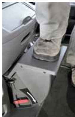
Die ausklappbare Stufe im Armaturenbrett erleichtert den Weg zur oberen Liege.
