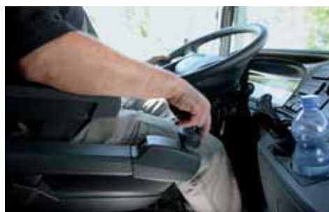
Die Bedienung von Powershift hat ihren Platz rechts am langen Hebel.
