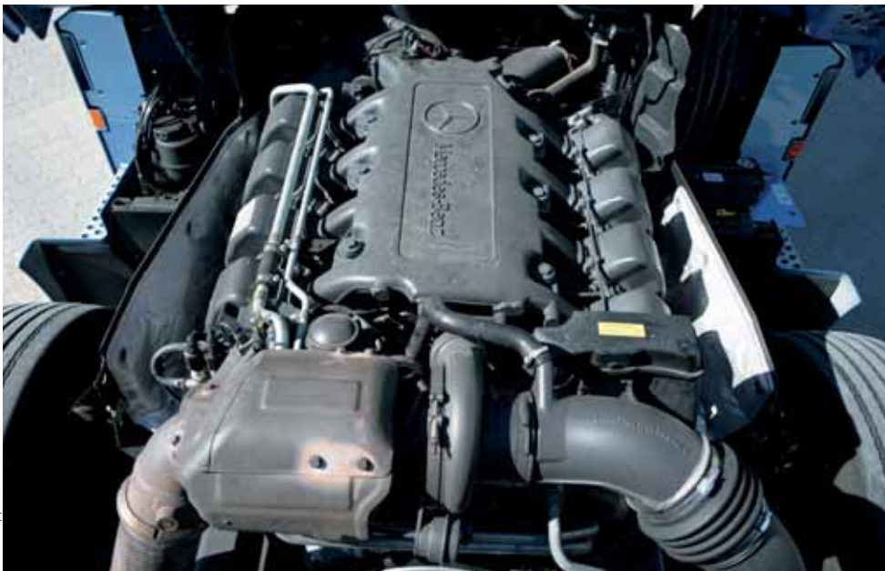
Ein großer, zentraler Lader versorgt künftig beide Zylinderreihen.
