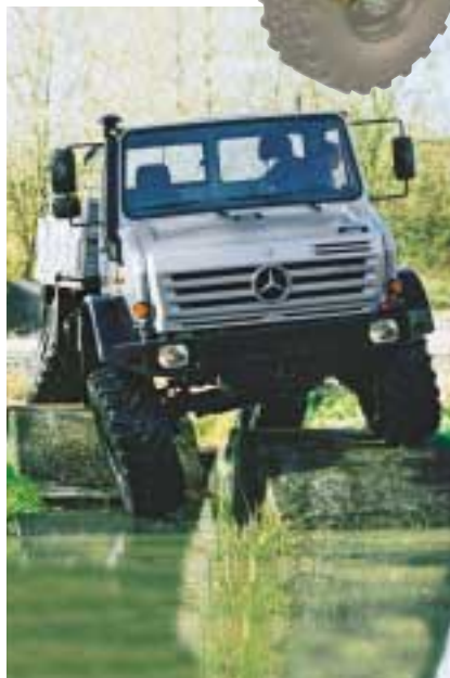
Ab ins Wasser: Unimog-Watttiefen von 800 oder sogar 1200 Millimetern.
