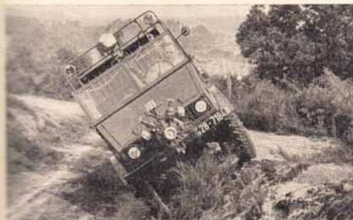
Keine Angst, es fällt nicht um! Der Unimog als Löschfahrzeug kann auch im Gebirge getreu eingesetzt werden, wenn es gilt, abgelegene Höfe zu schützen.
