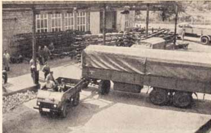
Im Werksverkehr müssen oft schwerste Anhänger rangiert werden. Dank großer Zughaakenleistung und Wendigkeit ist der Unimog auch hier sehr beliebt geworden.
