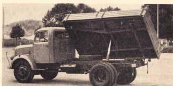
Der Kipper in Haubenausführung mit 3200 mm Radstand. Außerlich, wenn auch in manchem verbessert, ist die bekannte Mercedes-Form erhalten geblieben. Auffallend ist der hohe Nutzlastfaktor. (Verhältnis Nutzlast : Leergewicht.)
