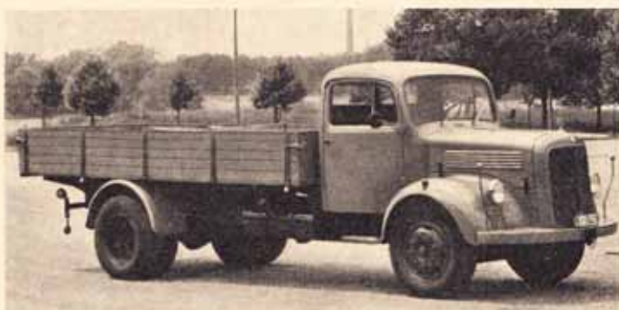
Von dem neuen Mercedes L 321 gibt es 19 verschiedene Ausführungen (Hauben- und Frontlenker, als Pritschenwagen mit drei Radständen, Kipper, Allrad und Sattelschlepper). Hier der Haubenwagen mit 4200 mm Radstand.
