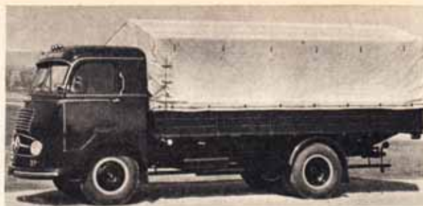
Links: Mit 3600 mm Radstand gibt es den 4 1/2-t-Mercedes nicht nur als Kipper und in Allradausführung, sondern auch als Sattelschlepper und als Sattelschlepper-Allrad.
