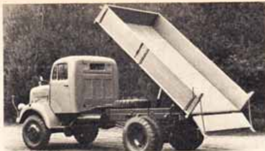
Links: Mit 3600 mm Radstand gibt es den 4 1/2-t-Mercedes nicht nur als Kipper und in Allradausführung, sondern auch als Sattelschlepper und als Sattelschlepper-Allrad.
