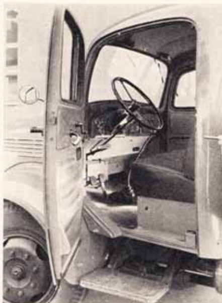
Blick in das Fahrerhaus der L-312-Haubenausführung. Bequemer Einstieg und Platz für 3 Personen sowie zweckmäßige Anordnung aller Bedienungsvorrichtungen. Kein übertriebener Luxus.
