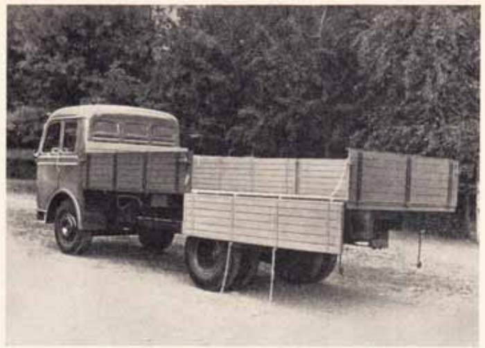
Die Pritsche des LP 315 ist mit zweiteiligen Seitenwänden ausgeführt, was das Umgehen mit diesen sehr erleichtert. Unter der linken Seitenwandhälfte ist der Bügel für die Reserveradhebevorrichtung zu sehen.
