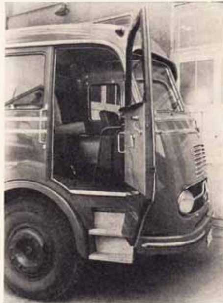
Der Einstieg in das Fahrerhaus. Zwei Tritte, deren oberer bei geschlossener Tür verdeckt ist.
