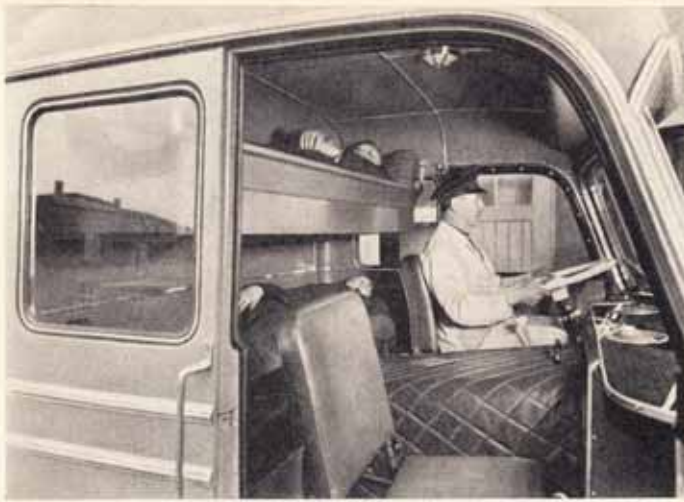
Die ausgesprochene Fernfahrerkabine bietet neben den Sitzen für Fahrer und Beifahrer auch noch zwei Schlafstellen. Die sorgfältige Isolierung des Motorraumes ist gut erkennbar.
