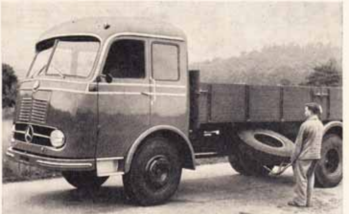
Die Reserverad-Hebevorrichtung erleichtert den Radwechsel sehr. Das Rad ruht auf einem Rohrgestell, das mit Hilfe eines Bügels herausgezogen und abgelassen werden kann.
